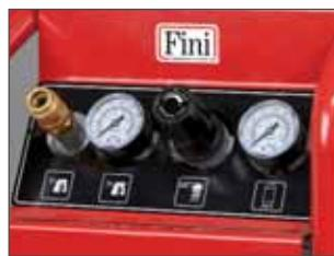
Comandi centralizzati nel pannello di controllo.
