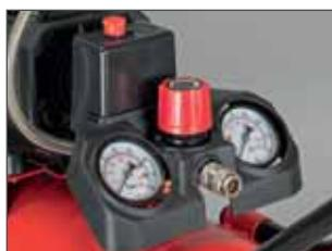
Comandi centralizzati nel pannello di controllo.
