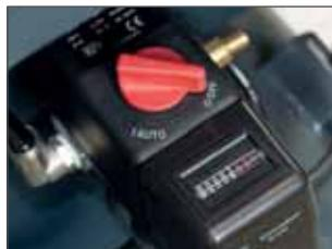
Interruttore di accensione ON/OFF e contatore posizionati sulla macchina in modo da garantire una facile lettura e utilizzo.
